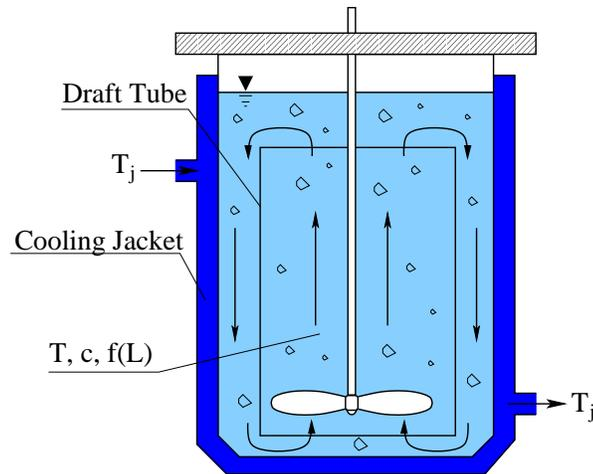
**Fig. 43:** Batch crystalliser
